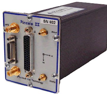
Figure 2. Piccolo II Airborne Avionics Package (Vaglianti et al., 2005:9)
